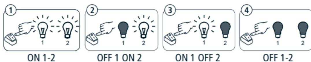
Avec les sorties allumées, à chaque pression longue (> 1 sec) du bouton filaire, les sorties 1 et 2 varient toutes deux de luminosité : la première fois, leur intensité augmente, et la suivante, l'intensité diminue, et ainsi de suite en alternance. Les sorties éteintes ne varient pas.
